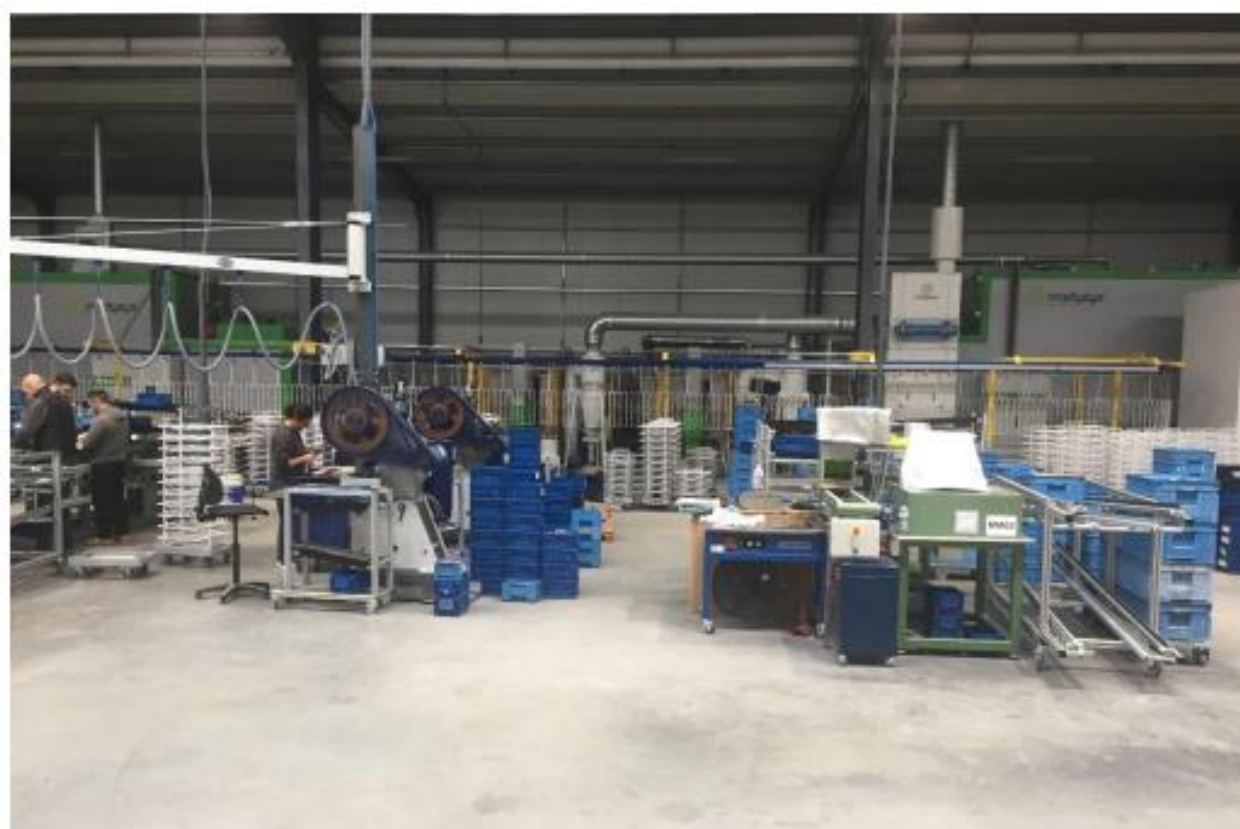
Figura 5: Equipamentos Diversos - Máquina Montar 50 (Direita) + Equipamentos de Cravação (Esquerda) + Linha Pintura (Ao fundo)
